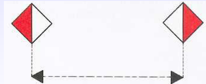
A.10. Zakaz przejścia poza skrajnią określoną tablicami (pod mostem, przez jaz)
